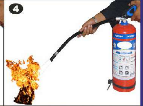
BLOW THE POWDER TO THE BASE OF FIRE પાવડરની ધારને આગના તળીયા ઉપર મારો. પાવડર કી ધાર કો આગ કે તહ પર મારીયે.
