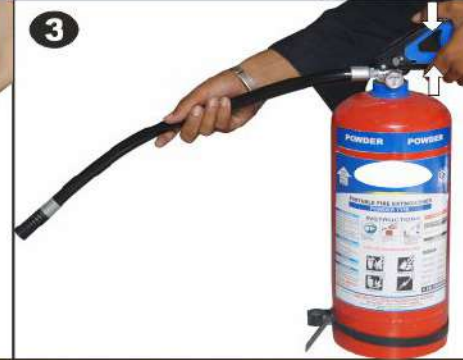
HOLD THE PIPE AND PUSH THE LEVER પાઈપને પકડીને લીવરને દબાવો. પાઈપ પકડકર લીવર કો દબાઈયે.
